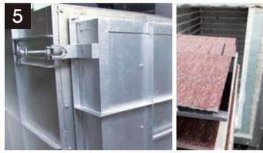
**5** 釉薬塗布後、焼成炉に入れ800度で焼成します。
