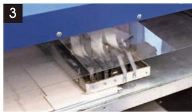
**3** フラットベッドプリンターからタイル表面に無色透明の接着性インクをダイレクト出力して、着色顔料を塗布していきます。
